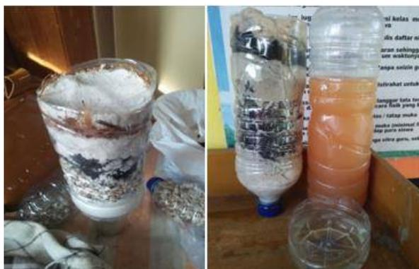
**Gambar 6. Alat dan bahan penjernih air sederhana**
